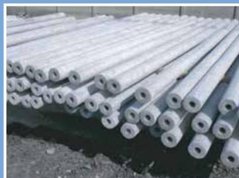
O fuste apresenta forma cónica, oco no interior e com uma superfície exterior lisa e homogénea.
